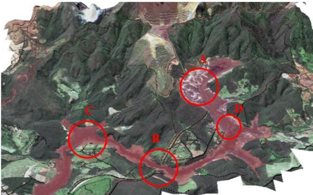
Figura 28- Representação em perspectiva das áreas onde ocorreram as principais interrupções da infraestrutura indicadas na Figura 27.
