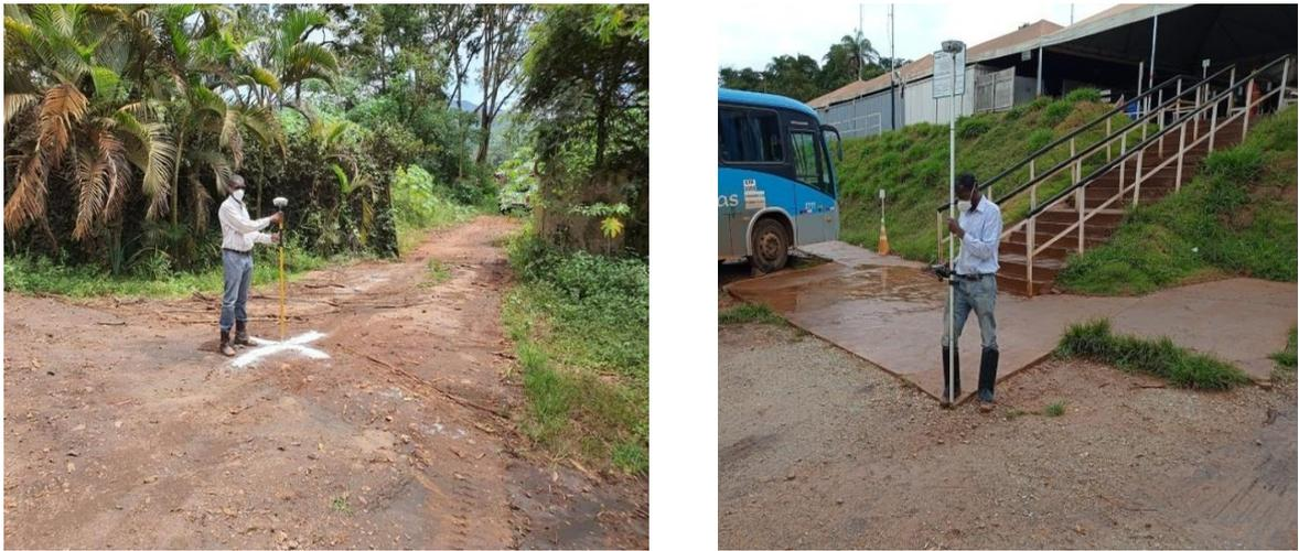
Figura 5 - Rastreamento com receptor volante em pontos foto identificáveis nas imagens drone.
