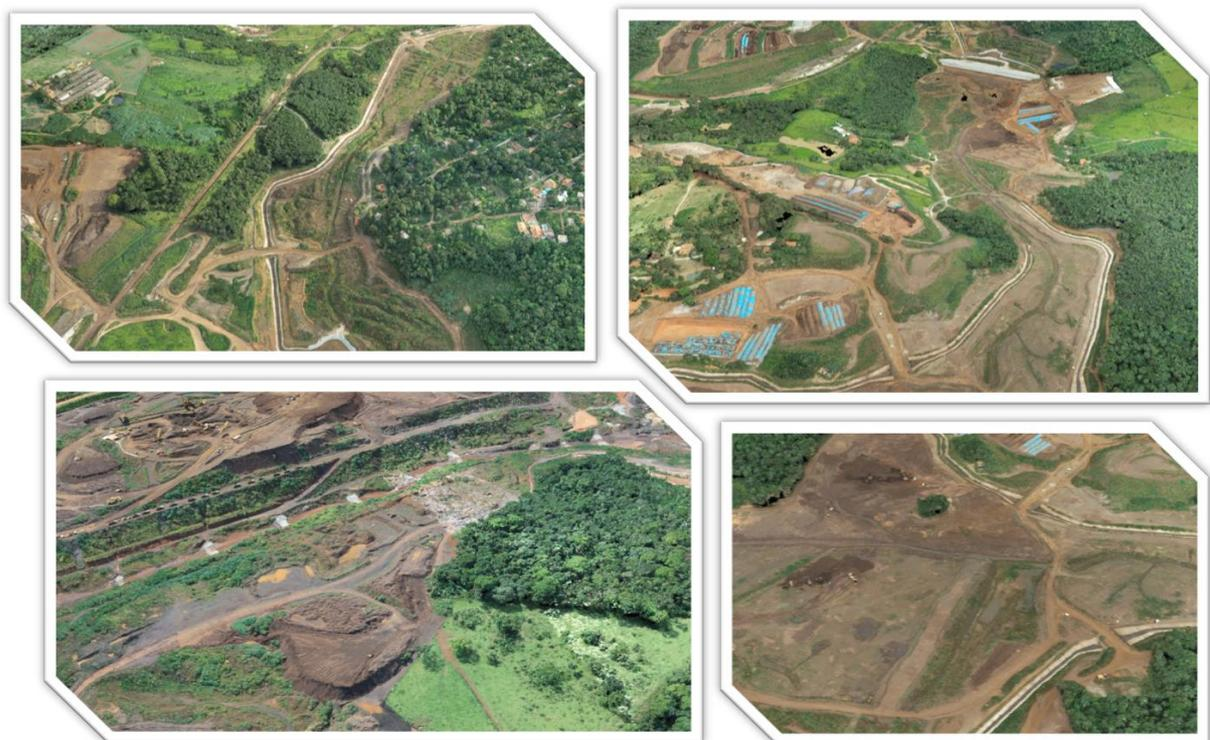
Figura 53 - Perspectivas sintéticas mostrando a situação das obras de recuperação e remodelagem dos cursos d'água e adjacências produzidas a partir de dados capturados por drone em fevereiro de 2021.
