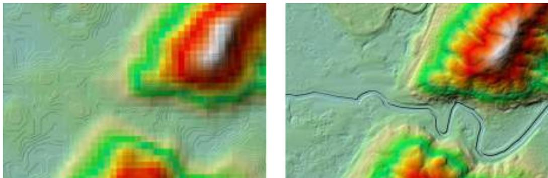
**Figura 01.** Modelo Digital de Terreno derivado do SRTM (pixel de 900m<sup>2</sup>) e do AW3D (pixel de 1m<sup>2</sup>)
